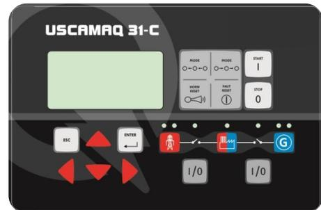
Controlador de funciones completo para la aplicación del grupo electrógeno con los siguientes modos: individual con paralelo a la red (SPTM) y usina (MINT) con funciones listas y configurables según las necesidades del cliente. Display con información en portugués y con botones que facilitan la navegación entre pantallas de medición.
